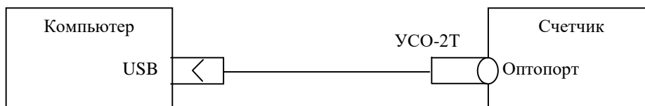
Рисунок В.2 - Схема подключения счётчика к компьютеру через оптопорт
